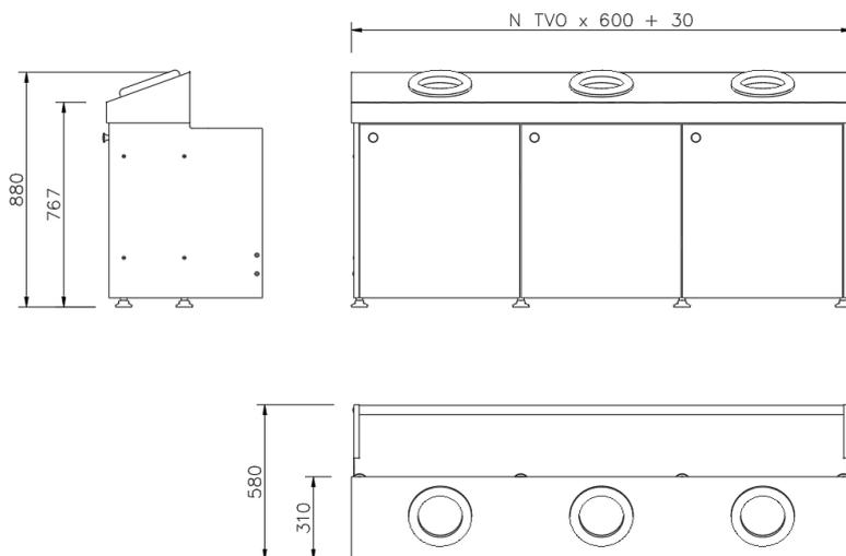
Le poste de tri sélectif permet aux convives de trier directement les déchets non alimentaires lors de la dépose de leur plateau sur le convoyeur à plateaux. Le poste de tri sélectif est implanté sous un convoyeur à plateaux.
