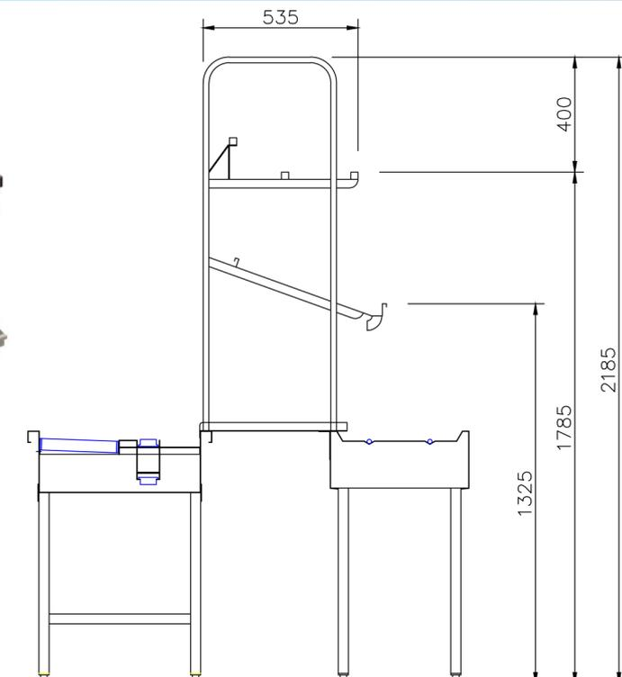
Permet de stocker et présenter pour remplissage des casiers à vaisselle. Les casiers sont placés devant l'opérateur puis ils sont poussés sur le convoyeur à casiers via une table de transfert.
