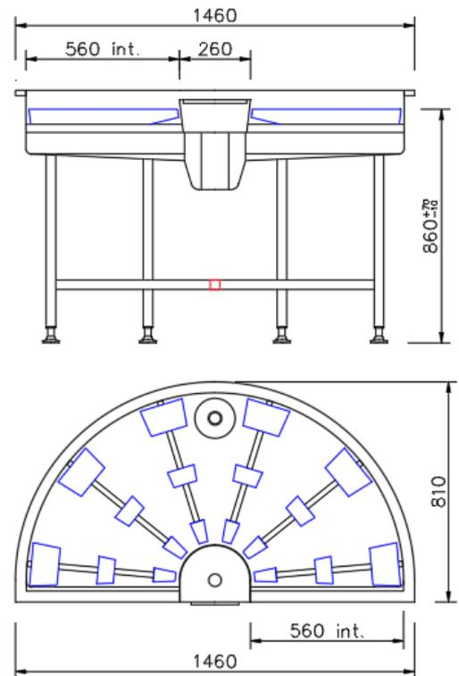
La courbe à rouleaux coniques composite permet de transporter les casiers de vaisselle vers la machine à laver avec un encombrement réduit.
