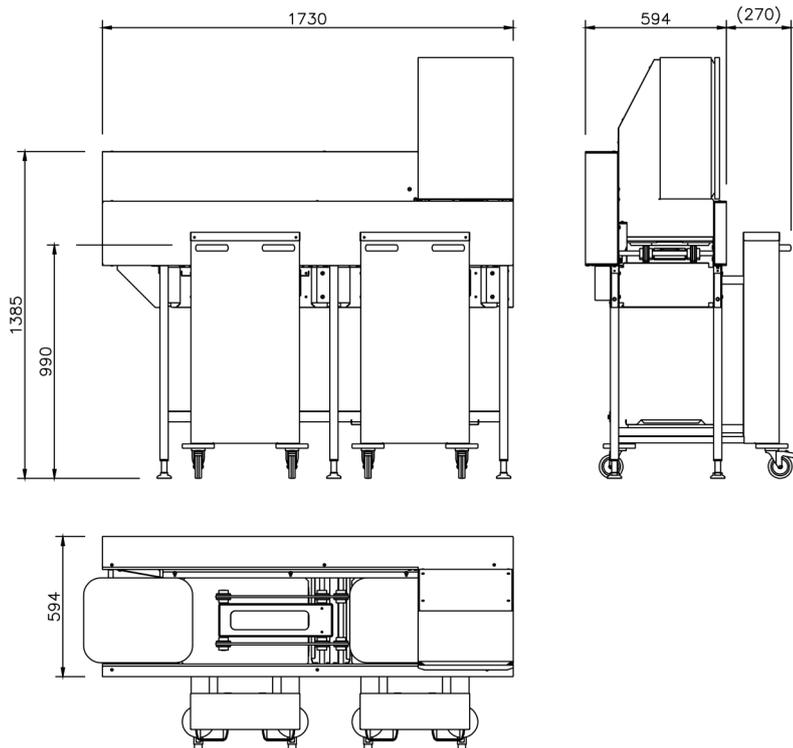
Le chargeur automatique de plateaux permet de charger indépendamment et automatiquement les plateaux sur 2 chariots en sortie de lave-plateaux.
