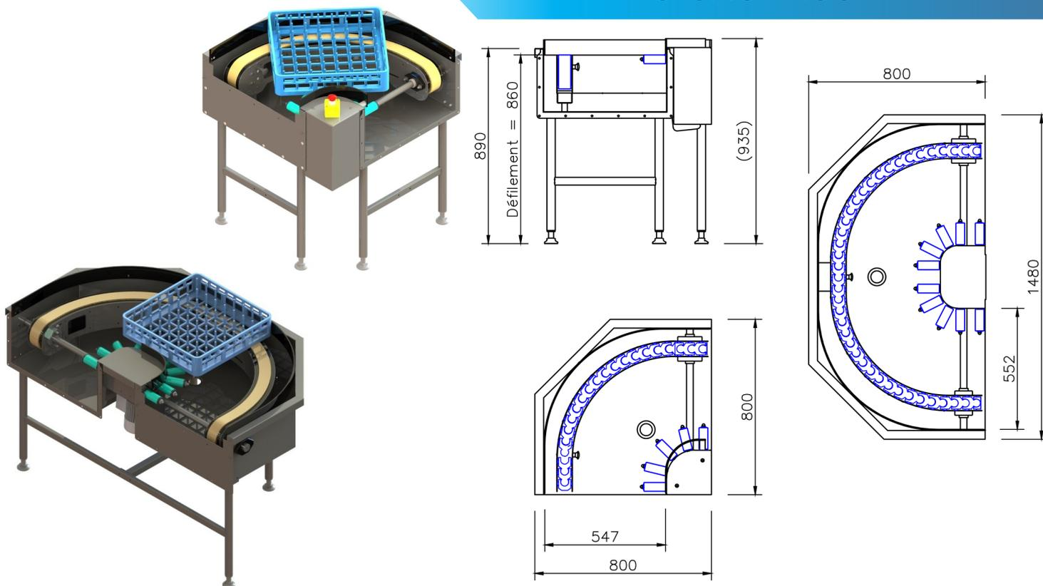
La courbe à cardans pour casiers permet de transporter les casiers à vaisselle vers la machine à laver.
