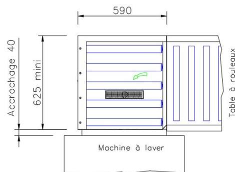
Le chargeur d'angle permet de charger un casier à vaisselle à 90° dans une machine à laver avec un encombrement réduit.
