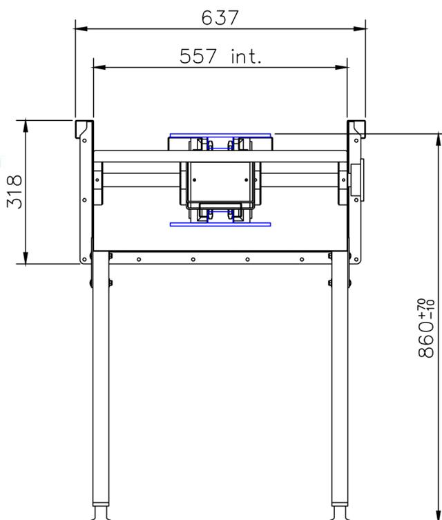
Le transporteur à palettes permet de transporter les casiers de vaisselle vers la machine à laver.
