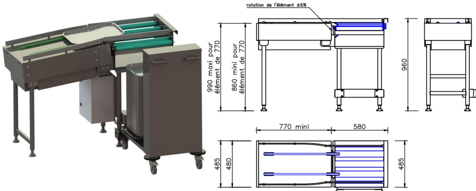
Le chargeur automatique de plateaux permet de charger latéralement des plateaux sur un chariot à niveau constant.
