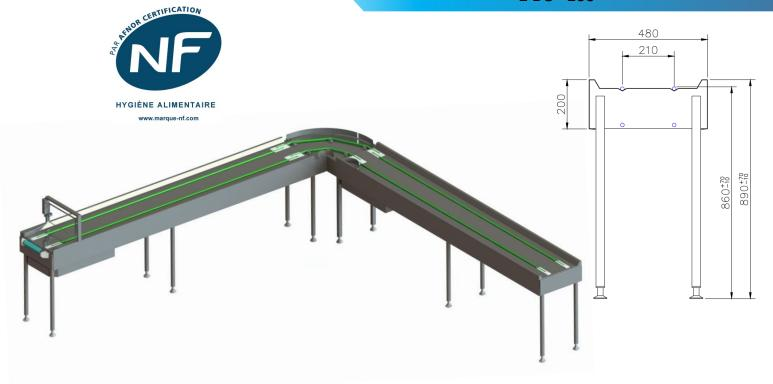
Le convoyeur à cordes permet de transporter des plateaux repas de la salle de restaurant jusqu'à la laverie. Il s'adaptera à la plupart des configurations grâce à sa réalisation sur-mesure.
